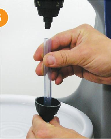
Remueva la tuerca de la manguera de succión del Dosatron. Inserte la manguera por la tuerca y sujétela la manguera a la lengüeta.
