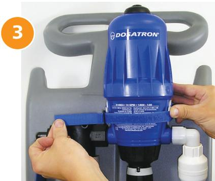
Fije el ensamble de la unidad-Kit al soporte instalado en el carro. Asegúrelo con la correa de la unidad.
