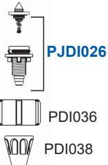
2. Desatornille la tuerca de la manguera de succión (PDI038) y la tuerca de la válvula cheque (PDI036). Saque la válvula cheque (**PJD1026**), note la orientación del cono y el resorte interno de la válvula.
